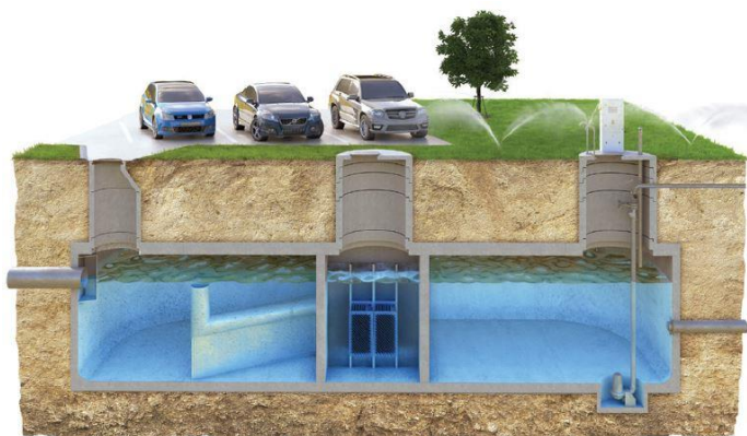
Ryc. 11 Zbiorniki podziemne, źródła (od lewej): https://www.uponor.pl/ ; https://ecol-unicon.com/produkty/produkty-deszczowe/zbiorniki-retencyjne-hydrozone/
